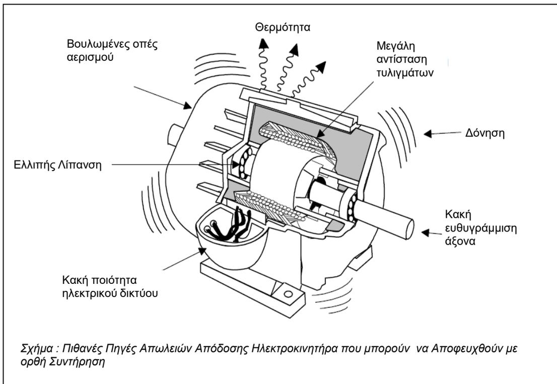
**1. Έλεγχος κατάσταση μόνωσης τυλιγμάτων κινητήρα**
