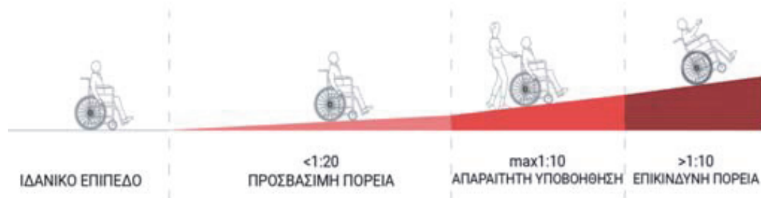
Σχήμα 3: Κίνηση χρήστη αναπηρικού αμαξιδίου σε ράμπα
