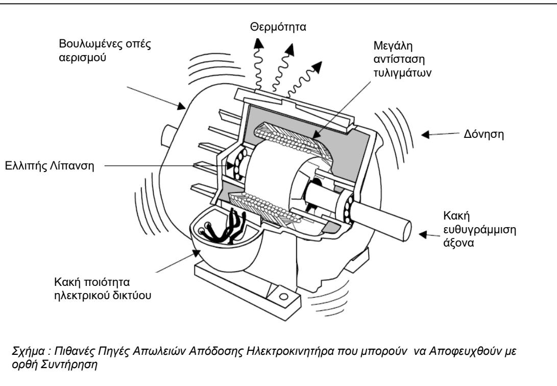
**1. Ελεγχος κατάσταση μόνωσης τυλιγμάτων κινητήρα**
