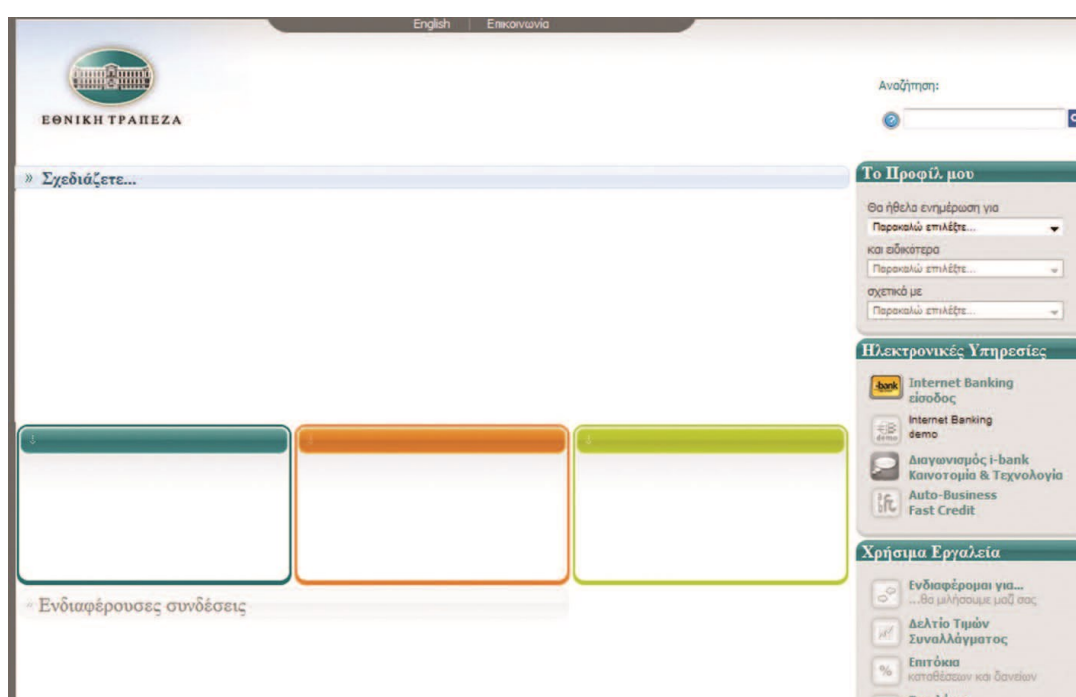
Εικόνα 16. Εμφάνιση της αρχικής σελίδας του ιστοχώρου της Εθνικής τράπεζας με τη χρήση Javascript απενεργοποιημένη. Ο τελικός χρήστης δεν είναι σε θέση να αλληλεπιδράσει με το περιεχόμενο της σελίδας εφόσον αυτό δεν εμφανίζεται.
